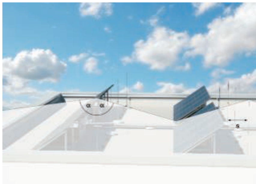
\alpha^\circ = zibens novadīšanas aizsargleņķis, s = atstarpe
