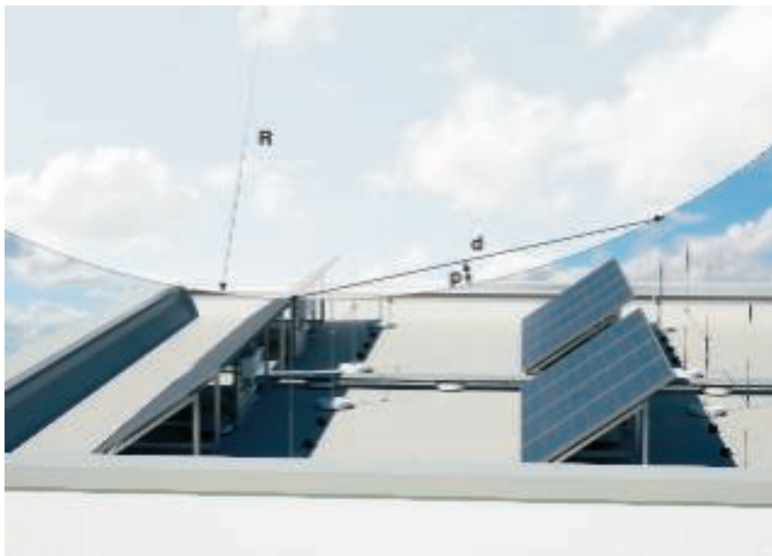
p = iespējamās dziļums, R = zibensaizsardzības lodes rādiuss, d = uztveršanas iekārtas attālums
