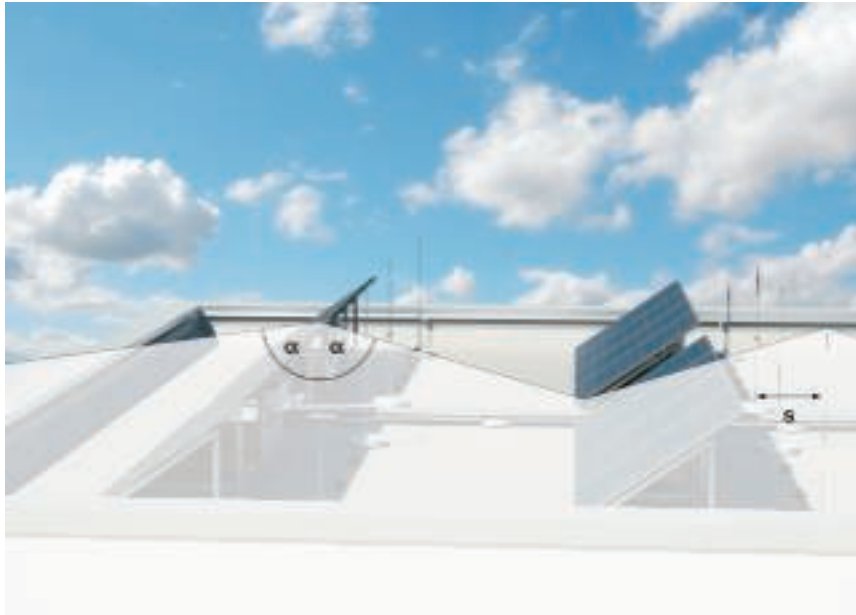
\alpha^\circ = zibens novadīšanas aizsargleņķis, s = atstarpe
