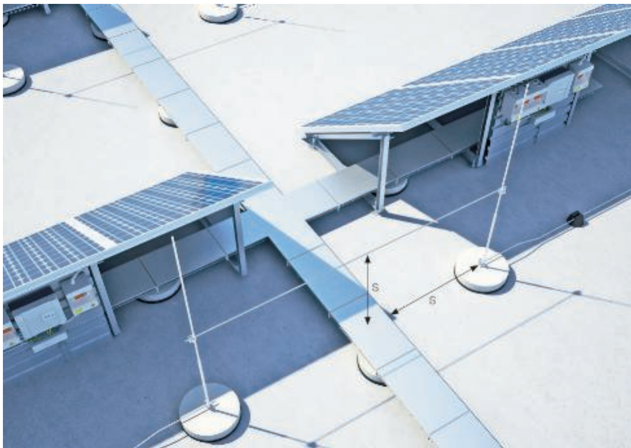
Atstarpe(-s) starp zibensaizsardzības iekārtu un kabeļu nesošo sistēmu
