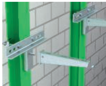
Spīļveida stiprinājums pie vertikālas tērauda sijas KA-AW tipa adaptera plāksnes montāža pie vertikālām tērauda sijām ar fiksācijas leņķiem vai aptverēm. Izmantojot SKS 12x40 GF tipa sešstūra skrūvi, pie adaptera plāksnes nostiprina AW tipa sienas balsteņus.
