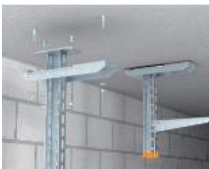
Adaptora augšējā plāksne, nesimetriska Nesimetriska augšējā plāksne KA-ASY nestspējas palielināšanai kombinācijā ar US 7 K un IS 8 K tipa iekārtajiem statņiem.
