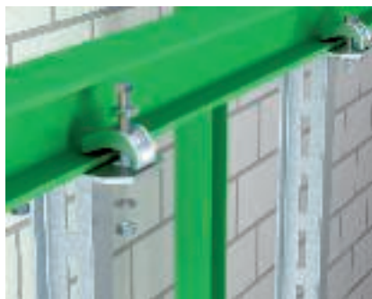
Tieša nofiksēšana pie sijas I-veida iekārtā statņa tieša nofiksēšana pie sijas ar TKS-S-30 tipa spīļiem (smagais konstrukcijas). Trases virziens ir gareniski gar tērauda sijām.
