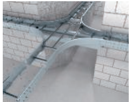
Krusteņa montāža Krustenis kombinācijā ar gara laiduma kabeļu trepēm. Izmantojot ārējos savienotājus, krusteni savieno ar gara laiduma kabeļu trepēm.
