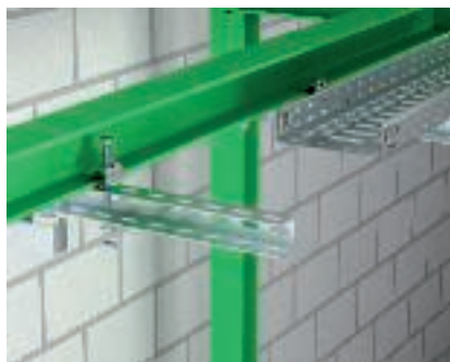
Konsole pie sijas U-veida statņa kā konsoles montāža pie tērauda sijas. Atkarībā no slodzes nostiprina ar fiksācijas leņķiem vai spīļiem. Nostiprina ar DSK tipa paplāksnēm.
