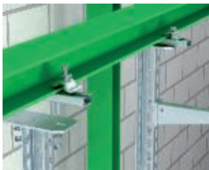
Spīļveida stiprinājums ar papildu C profilu Papildu CPS tipa C profila sliedes izmantošana, ja ir platas tērauda sijas. Trases virziens ir gar tērauda sijām.
