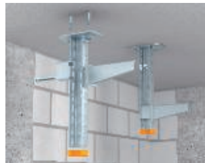
Iekārtā statņa standarta montāža ar sienas balsteņiem vienā pusē, izmantojot paplāksni Iekārtā statņa nostiprināšana pie griestiem ar vienā pusē piemontētu balsteni. Sākot no 400 mm platumā, ieteicams izmantot paplāksni.
