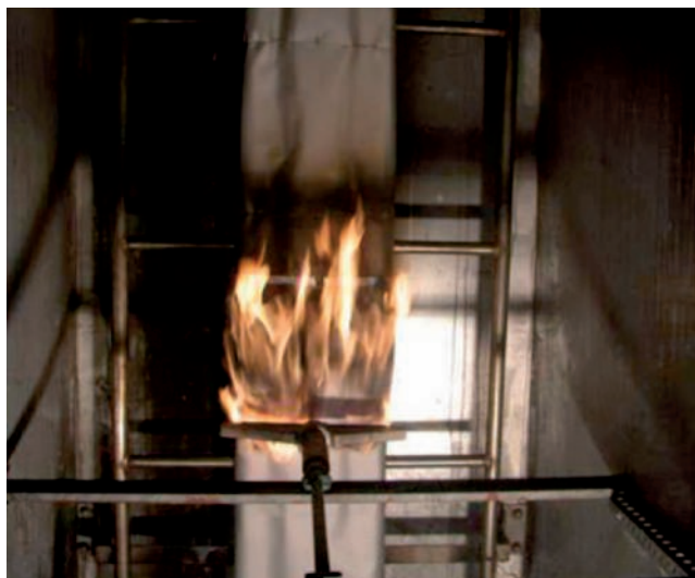
Kabeļu bandāžas pārbaude
