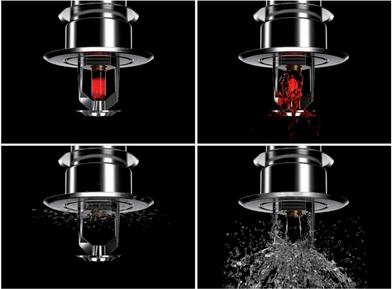
Smidzināšanas galvas aktivizēšana, pārsniedzot nominālo temperatūru 68 °C pie stikla trauciņa
