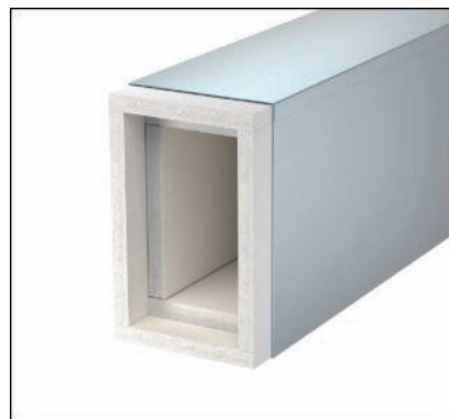
Metāla kanāls ar kalcija silikāta plātnēm; savienojums ar gropi un atsperi
