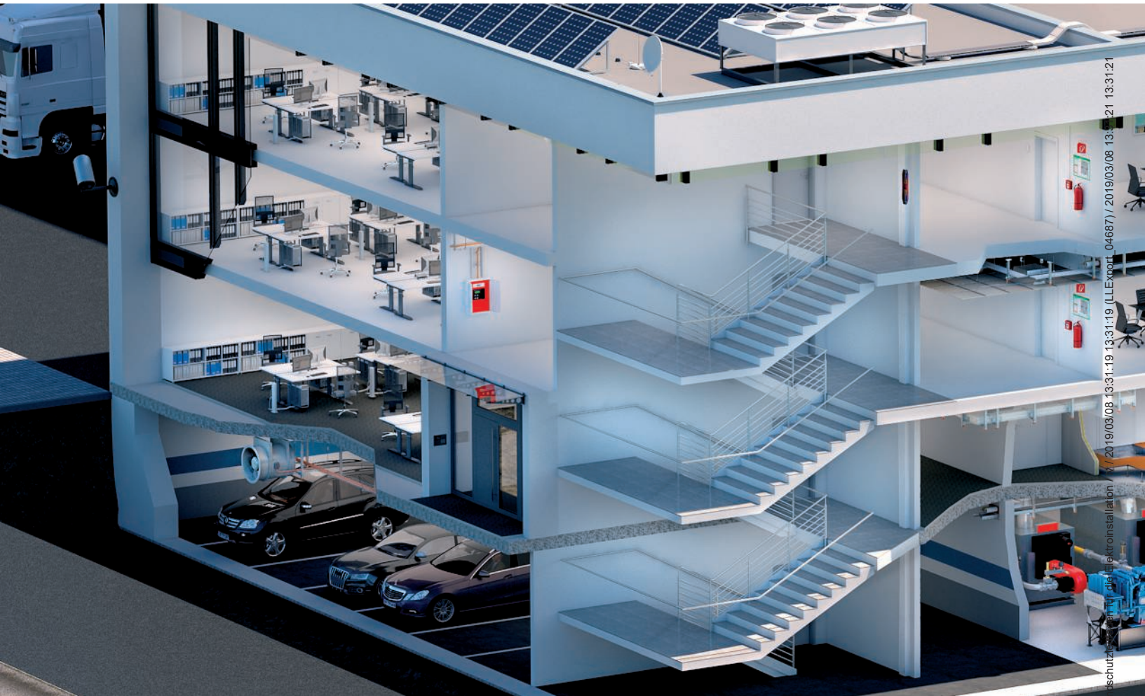
Ugunsgrēka zonu veidošana, izmantojot ugunsdrošības sienas vai būvdetaļas, kas ir izturīgas pret uguni
