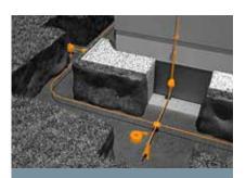
**Type A** – earth rod with equipotential bonding
